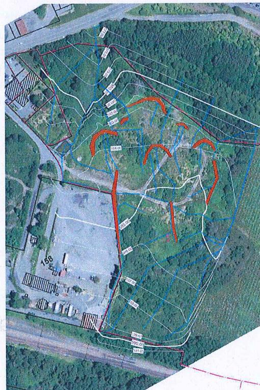
Figure 9 : Mise en place de merlons, aménagements hydrauliques
