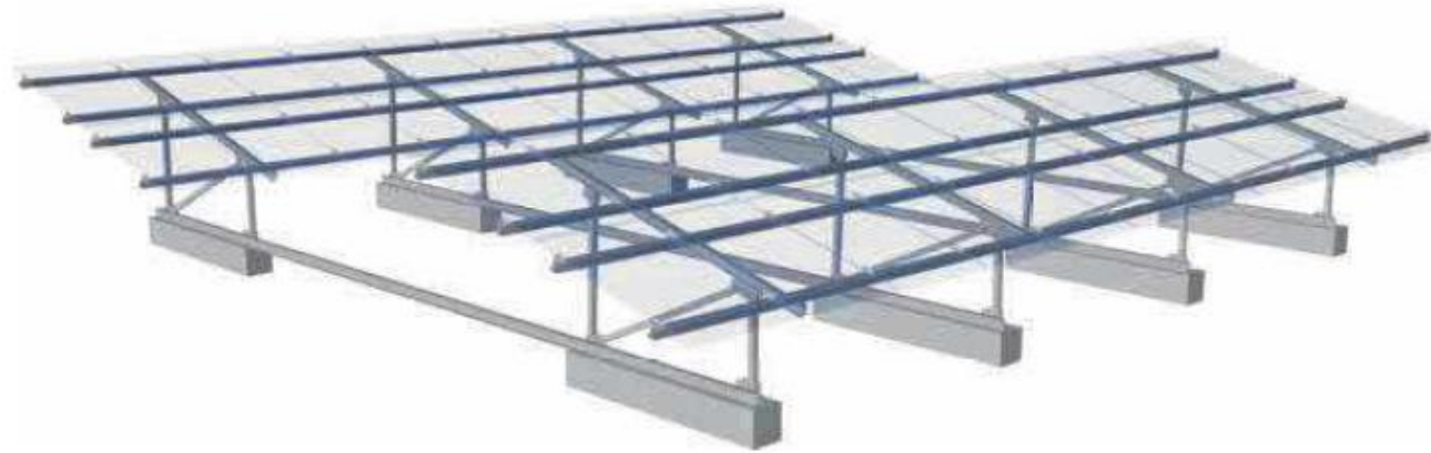
Figure 11 : Système permettant de relier les rangées de panneaux
