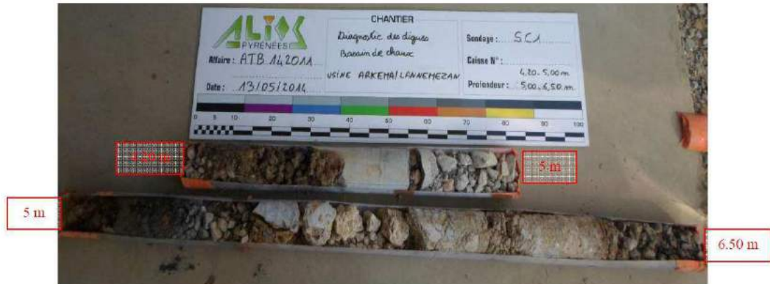
Figure 14 : Extrait du log géologique du sondage carotté SC1 (entre 4,2 et 6,5 m de profondeur)
