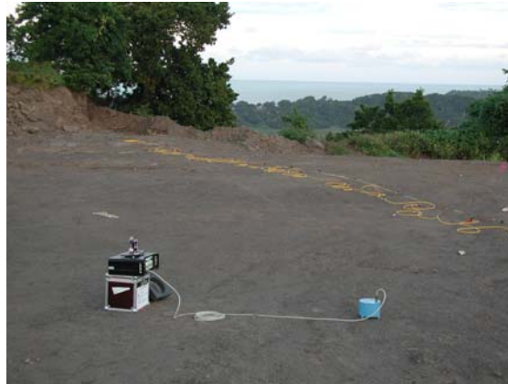
Figure 31 - Dispositif H/V utilisé à Mayotte (à gauche : la station d'acquisition et à droite : le sismomètre tridimensionnel 5 secondes).
