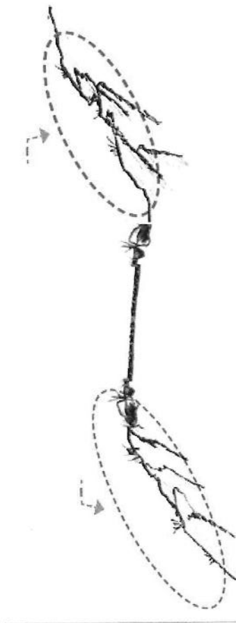
1. En... Reconstitution d'accotements amont et aval (1er lacet de piste) par semis irréguliers à l'hydroseeder des parois avec une composition des graines de flore rocheuses.
