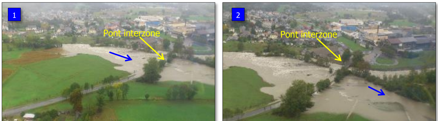
Figure 49 : (1) et (2) → Impact du pont interzone sur les écoulements lors de la crue de 2012. Le gave a largement débordé sur sa gauche, la ripisylve permet de matérialiser la berge de rive droite (photographie : Gendarmerie nationale)
