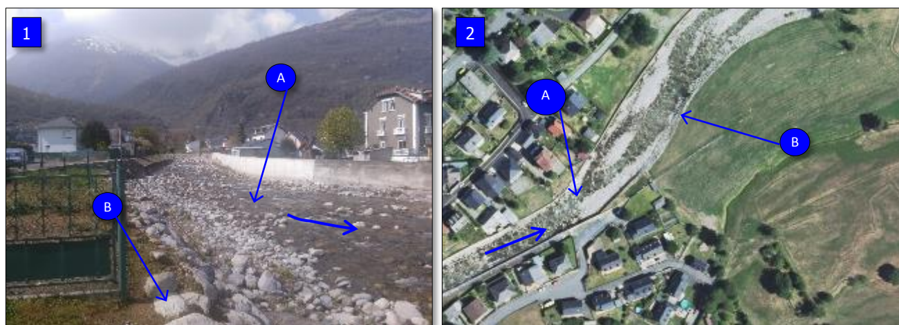
Figure 45 : (1) → zone de l'apex fixé du cône résiduel (début d'ouverture de la section et début du masque rocheux); (2) → zone de l'apex (A), on note le désaxement du lit et le masque rocheux (B) en rive droite ainsi que le mur-digue en rive gauche. Le lit commence à divaguer voire tresser.
