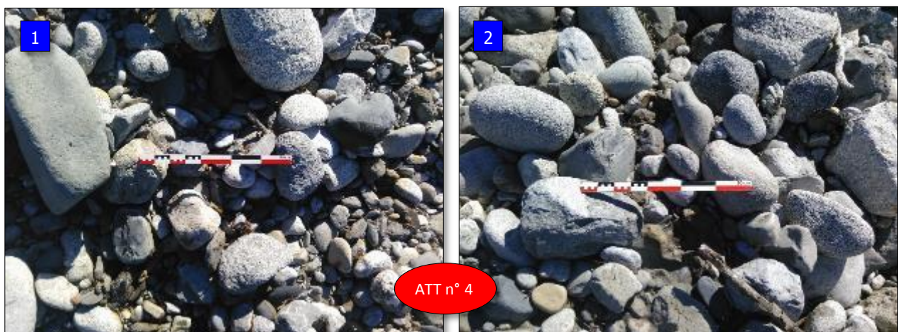
Figure 38: (1) et (2) → Matériaux de l'atterrissement n° 4 à granulométrie étendue et grossière dans la partie interne d'un atterrissement, entourée de zones plus grossières et par endroit de quelques passées sableuses (bed patchiness). Echelle de 50 cm.
