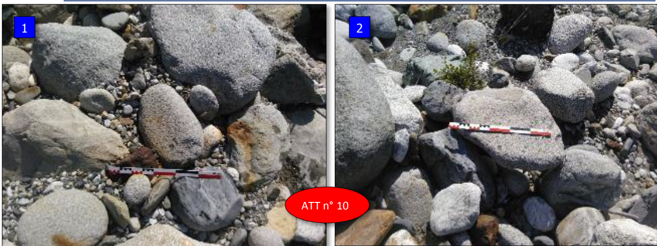
Figure 33 : (1) et (2) → Granulométrie très grossière sur l'atterrissement n° 10. L'échelle est donnée par la mire qui fait 50 cm
