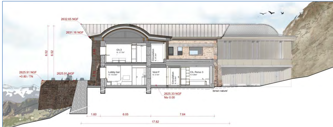
Illustration n°12 Coupe sur une chambre courante de l'existant
