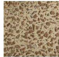
01 - Béton bouchardé avec agrégats coordonnées teinte de la pierre du site
