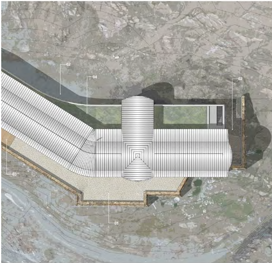
01 - Béton bouchardé avec agrégats coordonnées teinte de la pierre du site
