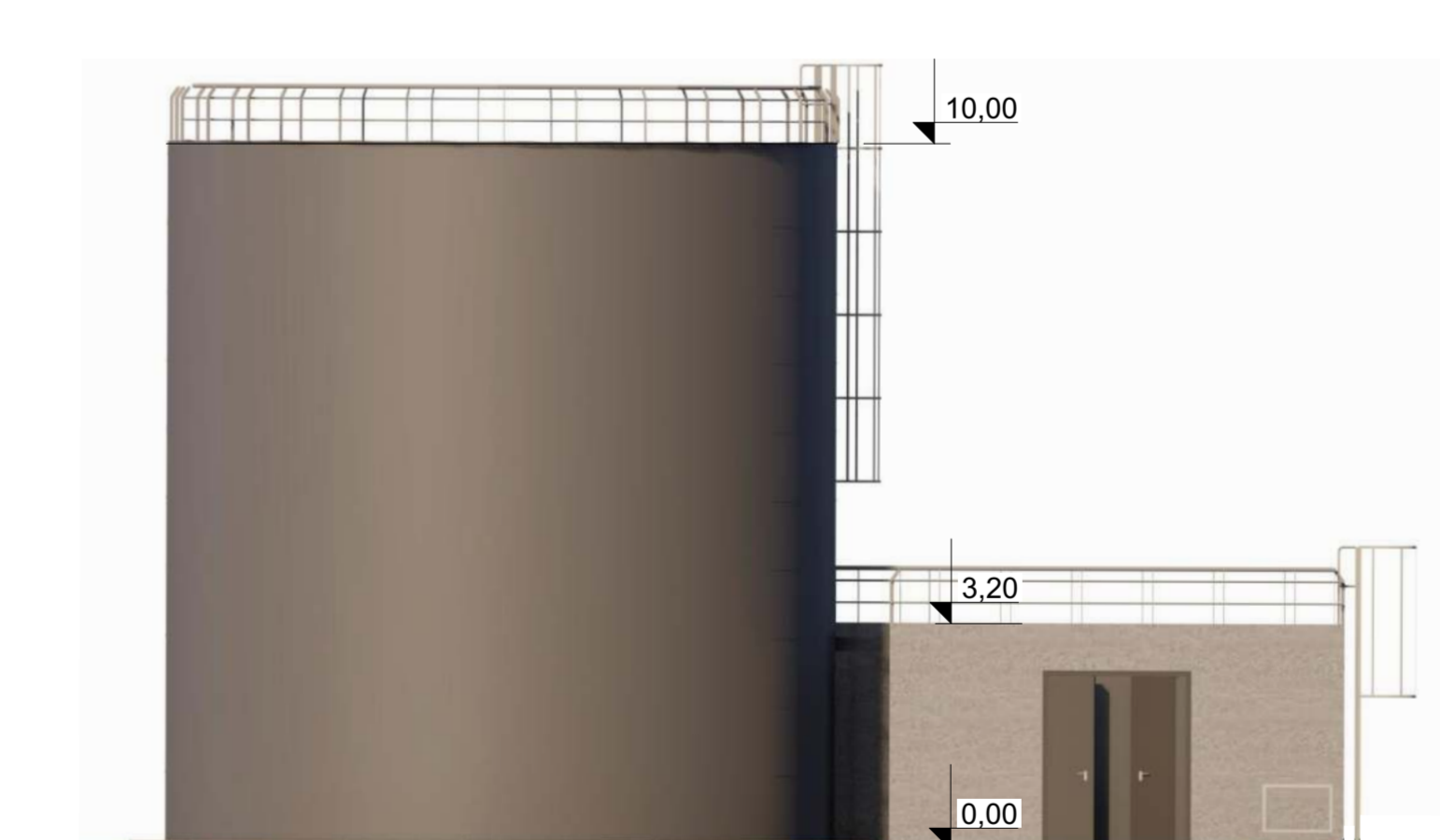
1:100 Façade Nord-Local sprinklage - PC5
