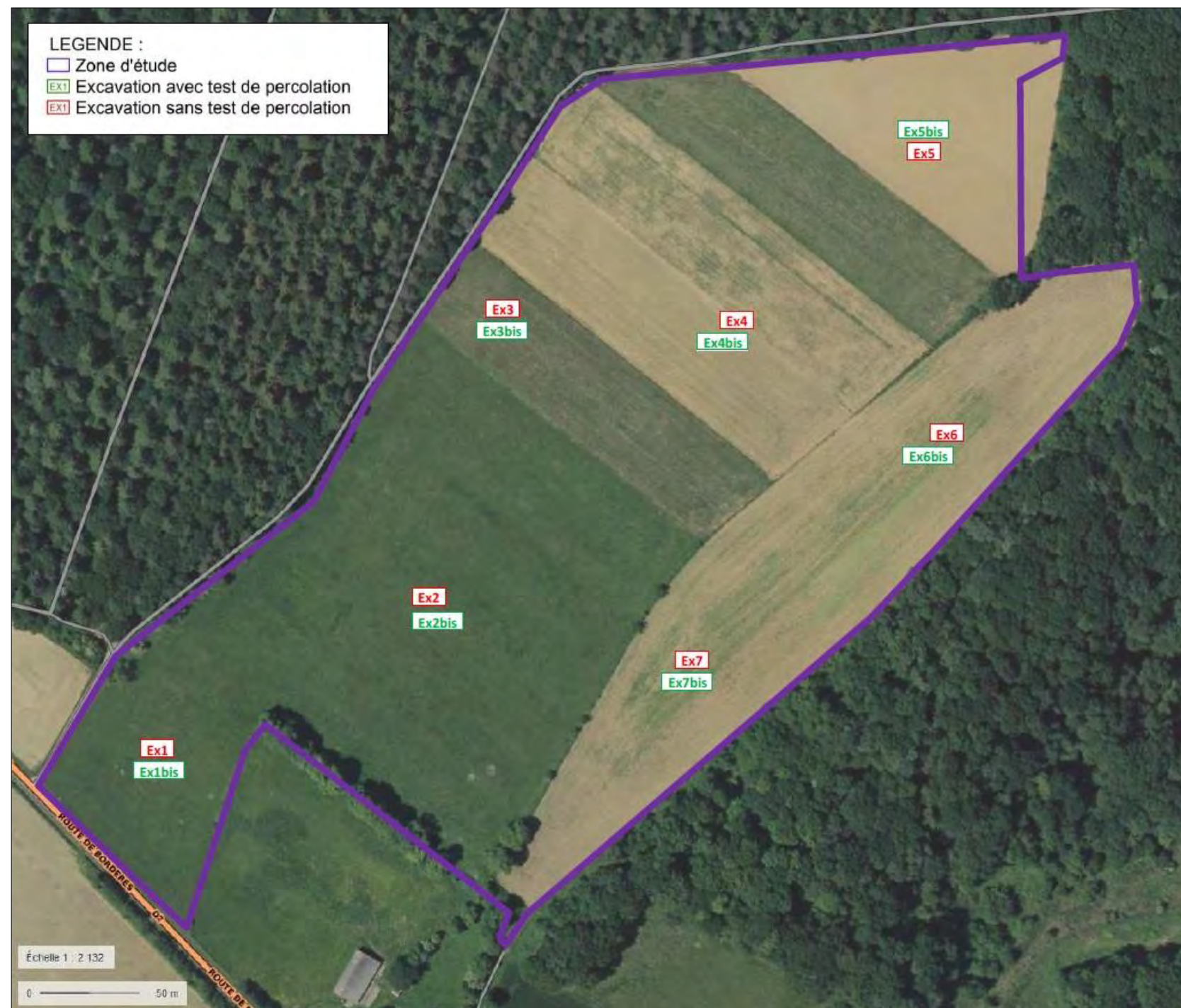
Figure 16: Localisation des sondages réalisés sur site (Source : SOND&EAU)
