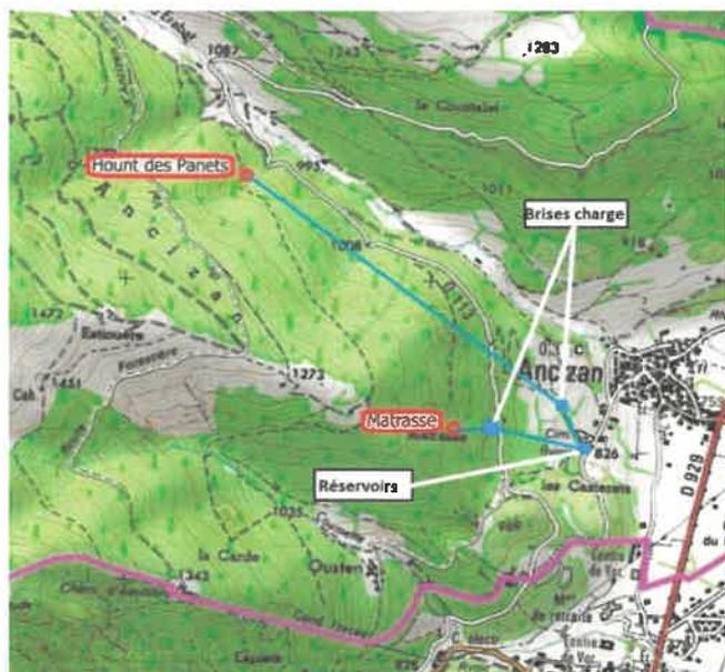
Les eaux captées rejoignent chacune un brise charge. Du brise-charge Hount des Panets, une première branche de distribution alimente le secteur haut-village. Le trop plein de ce brise-charge rejoint un groupe de 3 réservoirs, complété par l'eau venant du brise-charge Matrasse.
