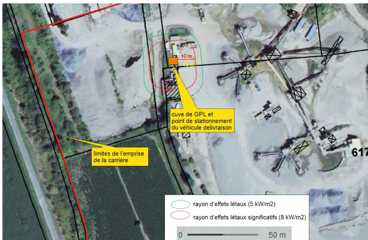
Zones d'effet létaux autour de l'aire de dépotage et de la cuve de GNR lors d'un incendie du camion de ravitaillement
