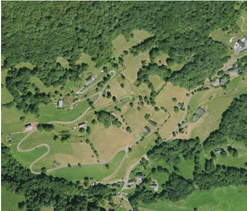
L'implantation du bâti rural est tributaire des usages agricoles, son inscription dans la pente lui confère protection et inertie thermique
