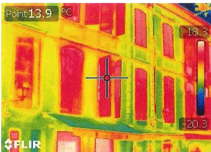
Clichés de thermographie réalisés en hiver sur des batis XVIII e et XIX e siècle. Mise en évidence des déperditions thermiques des fenêtres et de leurs allèges. L'allège est un point important du mur à isoler. Clichés Fébus-cohabitat?
