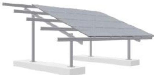
Schéma de principe d'une table (ou structure) en acier galvanisé portant 4 rangées de modules
