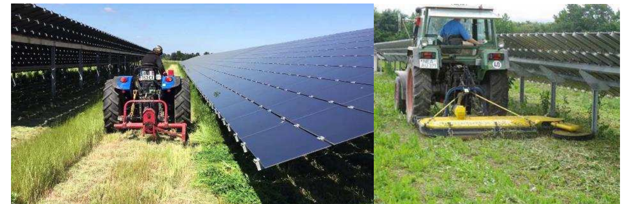
Figure 42 : Fauchage avec tracteur équipé d'une barre de coupe et d'un broyeur sous clôture
