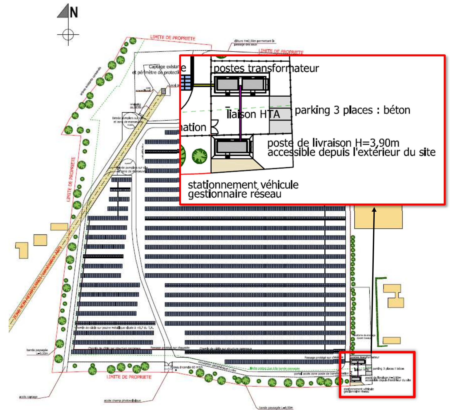
Figure 24 : Localisation des postes de transformation au sein du projet de parc photovoltaïque
