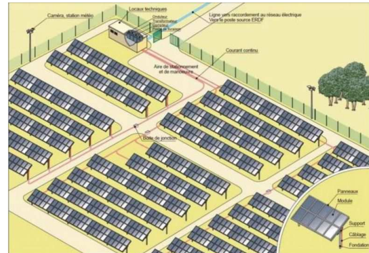
Figure 12 : Schéma de principe d'une centrale-type photovoltaïque
