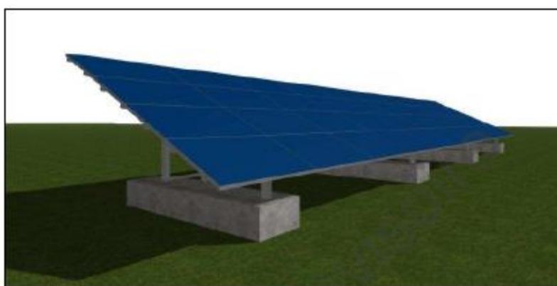
Figure 3 : Schéma de principe de panneaux sur une structure acier reposant sur des longrines
