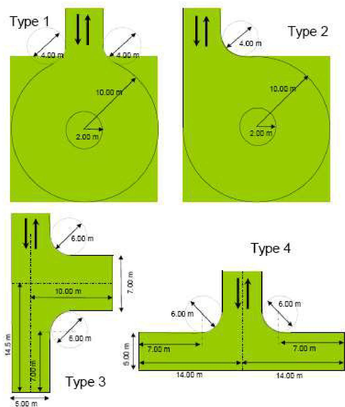
**Remarque :** Lorsque les voies échelles des ERP sont en impasse, il convient d'appliquer les dispositions de CO2 (largeur de 10 mètres dont 7 mètres de chaussée libre). Il n'existe pas de disposition semblable pour les habitations et les établissements industriels.
